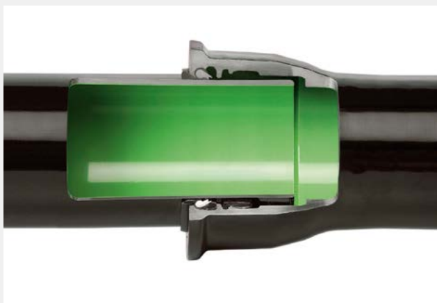
Fig. 13 Schubsicherung vonRoll HYDROTIGHT innenliegend mit hohem elektrischem Widerstand zur Verhinderung der elektrischen Längsleitfähigkeit.
