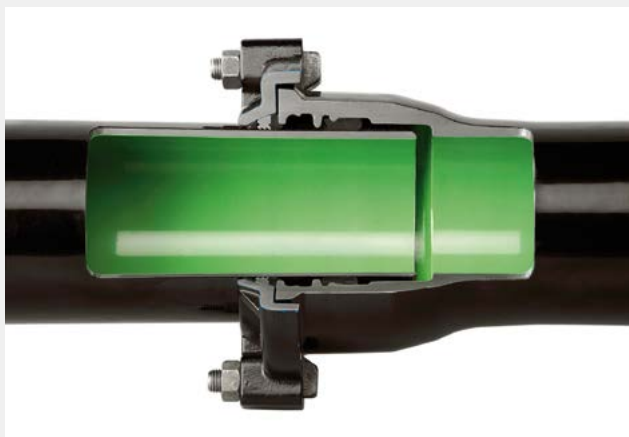
Fig. 12 Schubsicherung vonRoll HYDROTIGHT aussenliegend mit hohem elektrischem Widerstand zur Verhinderung der elektrischen Längsleitfähigkeit.
