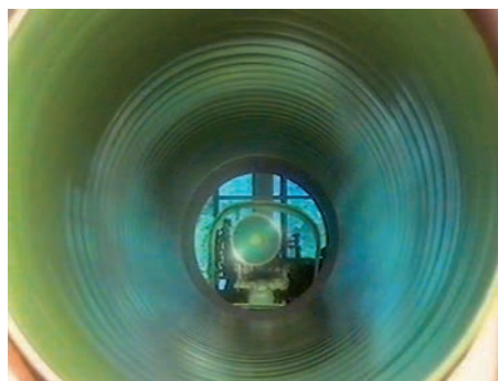
Rivestimento interno automatico in poliuretano (PUR).
